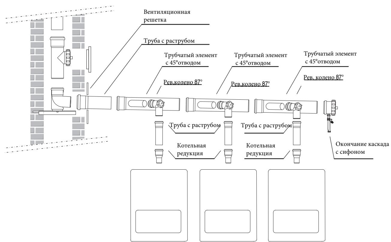
**Пластиковая дымоходная система для объединения в каскад (CAS)**
